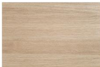
Bois, Mélèze vernis mat (charpente, menuiseries extérieures et occultations)
